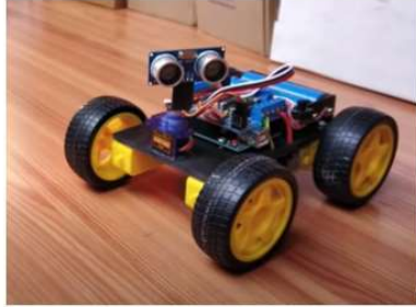
Mô hình xe đồ chơi hỗ trợ tính năng nhận diện và chuyển hướng khi gặp các chướng ngại vật (Phát triển trên mạch Arduino).
