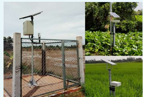
Hệ thống giám sát điều kiện môi trường sản xuất lúa hữu cơ tại tỉnh Sóc Trăng
