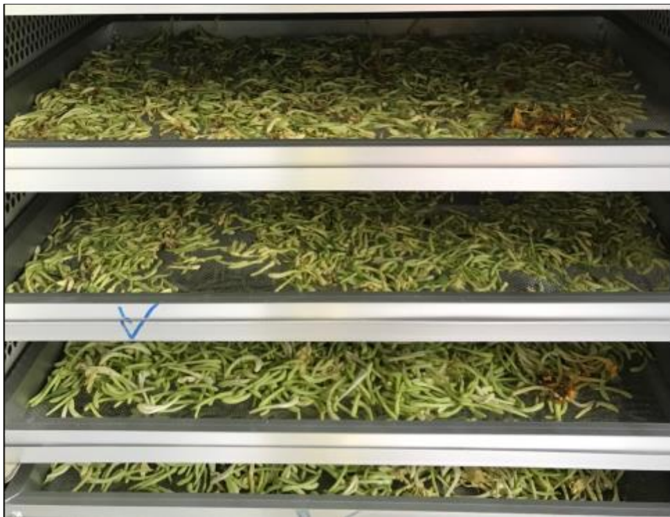
Hình 19. Công đoạn sấy lạnh trong quy trình sản xuất sản phẩm
